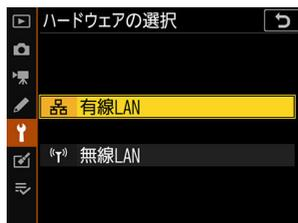
4 セットアップメニュー [有線 LAN/ワイヤレストランスミッター] > [接続設定] > [新規追加] > [接続ウィザード] > [FTP 画像送信モード] を選択する
