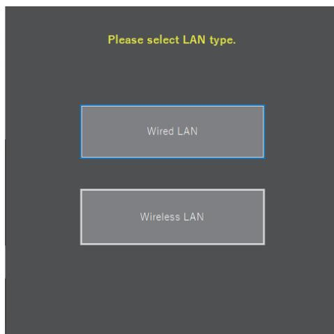
4. Sélectionnez [**Wired LAN**] (Réseau local câblé) > [**Create new profile**] (Créer un nouveau profil) et choisissez [**Fixed IP address**] (Adresse IP fixe) lorsque vous y êtes invité.
