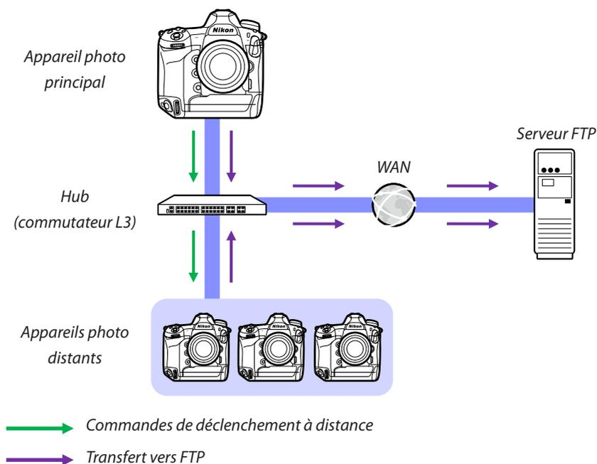
Prise de vue et transfert des photos avec un appareil photo principal et des appareils photo distants (déclenchement synchronisé)
