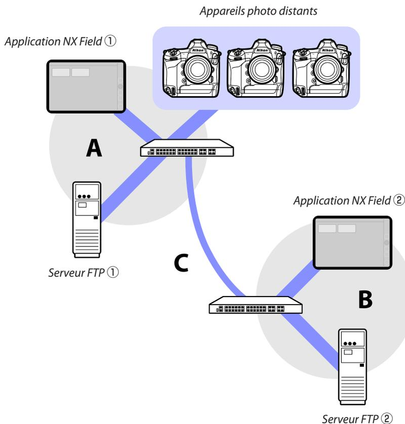
**Si les appareils photo distants, le serveur FTP et l'application NX Field sont sur le même réseau (réseau A) :**
