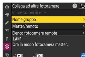
3. Selezionare **[Collega ad altre fotocamere]** > **[Master/remoto]** nel menu di rete e scegliere **[Fotocamera master]** o **[Fotocamera remota]**.
