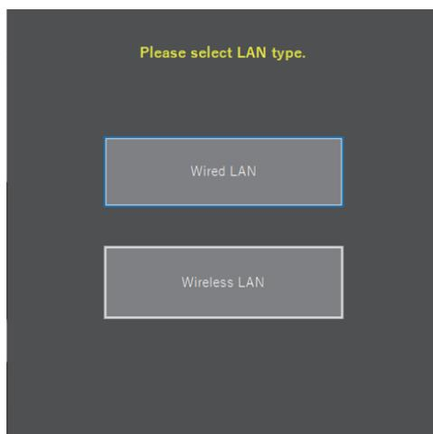
4. Selezionare [**Wired LAN**] (LAN cablata) > [**Create new profile**] (Crea nuovo profilo) e scegliere [**Fixed IP address**] (Indirizzo IP fisso) quando richiesto.
