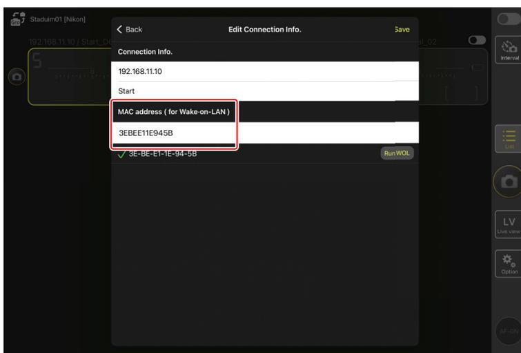
Utilizzo di Wake-on-LAN per attivare il timer di standby sulle fotocamere remote (solo D6)
