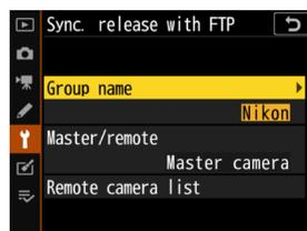
3. Выберите [**Master/remote**] на экране [**Sync. release with FTP**] и выберите [**Master camera**] или [**Remote camera**].
