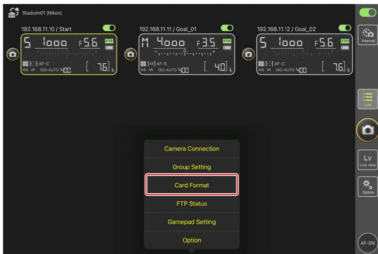
加亮显示包含存储卡的插槽并轻触 **[Starts formatting the card...]** (开始格式化存储卡...)。将显示一个确认对话框；轻触 **[OK]** (确定) 格式化该存储卡。
